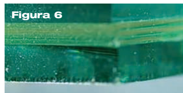
Figura 6_ Vetro stratificato tagliato e sfrangiature di bordo
